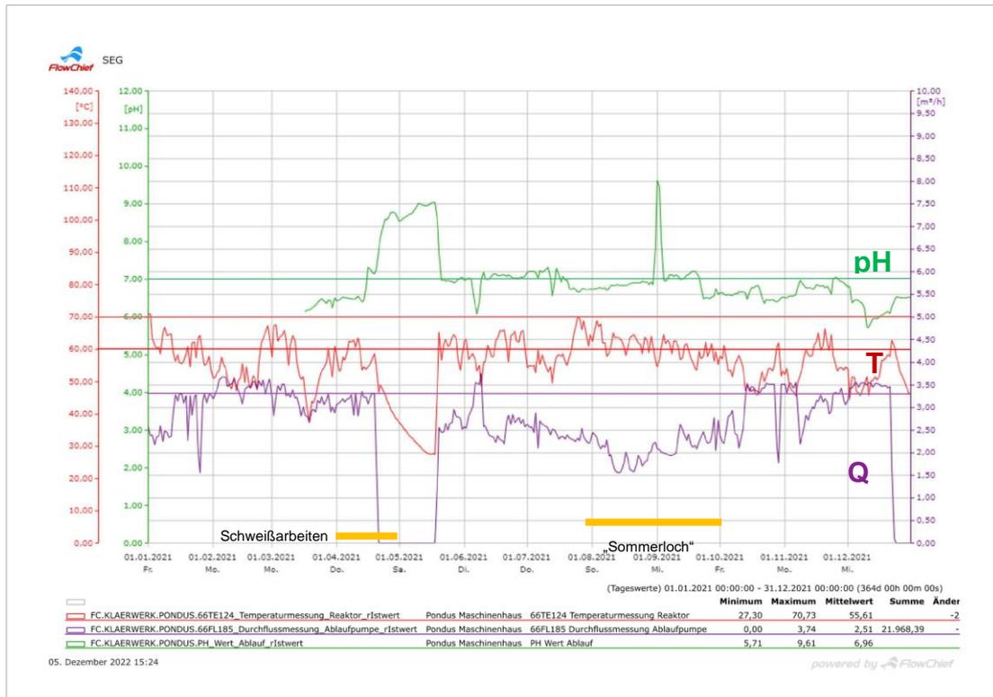
Abbildung 21: Jahrgang 2021 für Q, T, NaOH (Pondus-Anlage, Flow Chief)
