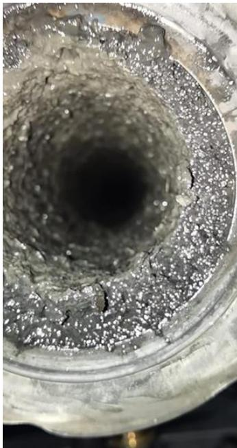
Abbildung 18: Ablagerungen in der Faulschlammleitung zum MAP-Reaktor mit weißen MAP-Kristallen
