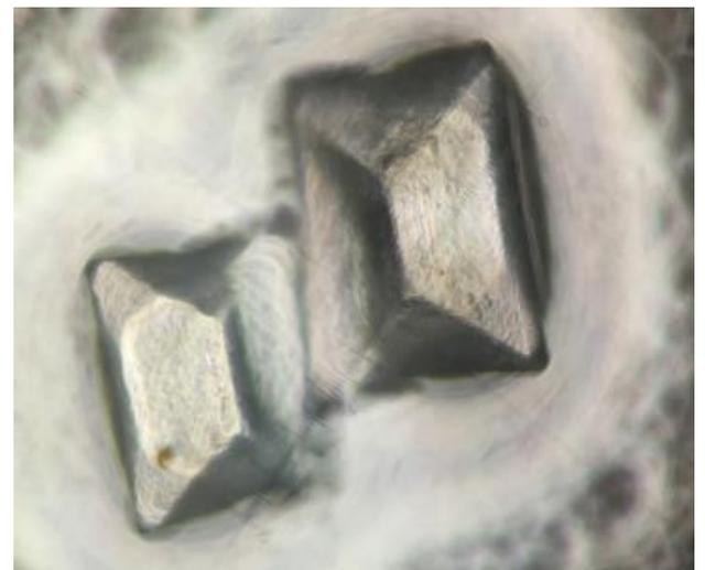
Abbildung 28: Struvit (MAP) im Abwurfcontainer und typische Sargdeckelform unter dem Mikroskop.
